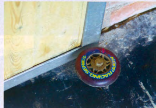
Geistes-Blitze: Mit Schweißbrenner und Grips verwirklicht Markus Wipperfürth seine Ideen – etwa Tränkebecken am Spieß, ein Regal auf der Rohrisololation und Inliner-Rollen am Tor.
