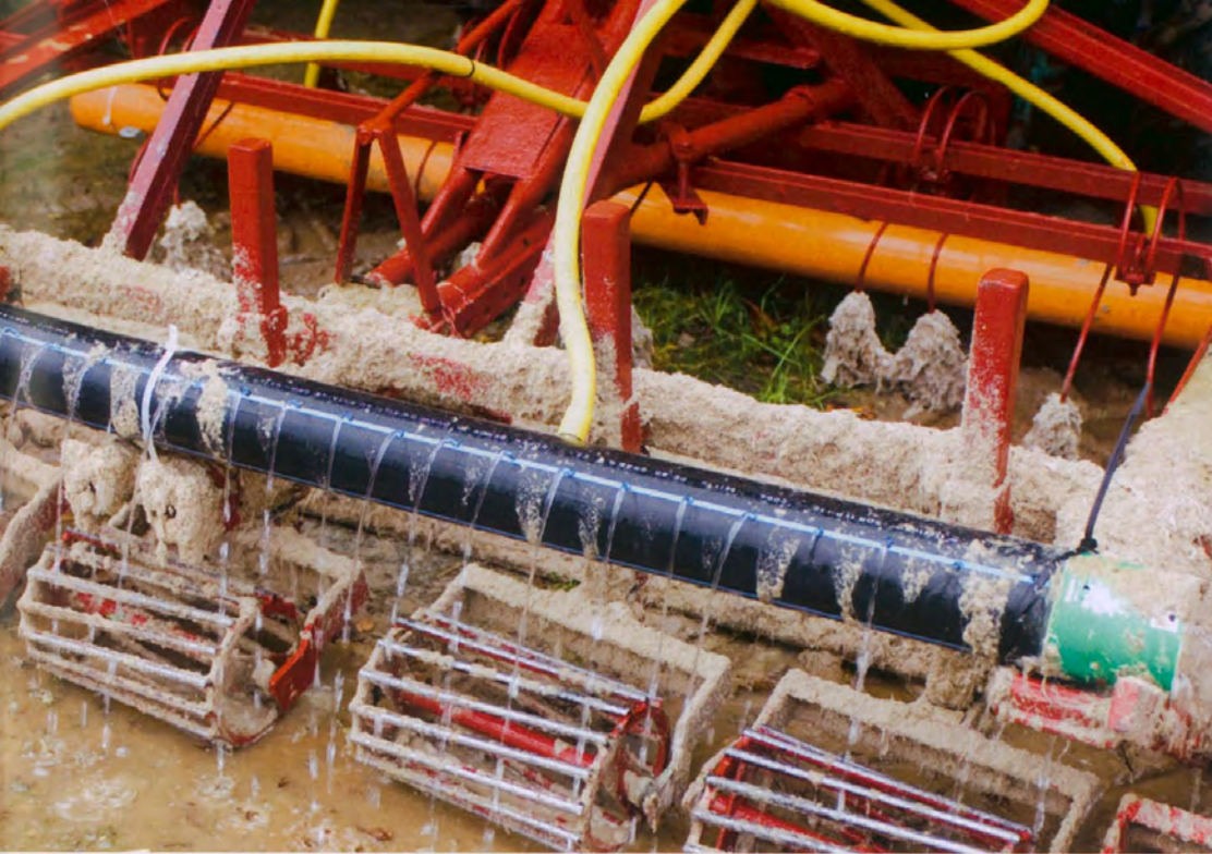
Maschinenbau: Bahnplaner und Beregung stecken in einem Gerät, das holznah an die Hallenbände heranfahren kann.
