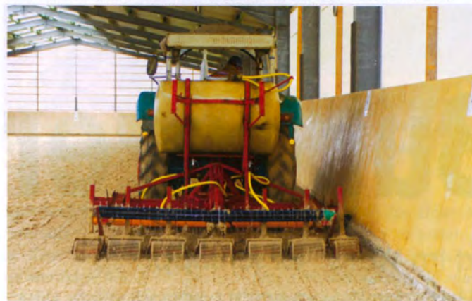
Maschinenbau: Bahnplaner und Beregung stecken in einem Gerät, das holznah an die Hallenbände heranfahren kann.
